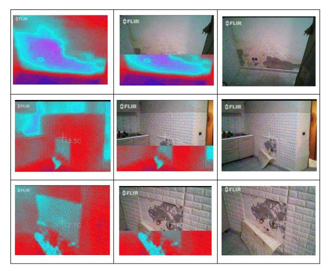
Di ogni foto sopra riportata e realizzata con l'ausilio di termocamera FLIR, si può vedere della stessa immagine, la foto effettuata con la termo-camera, la foto in sovrapposizione e la foto normale.
