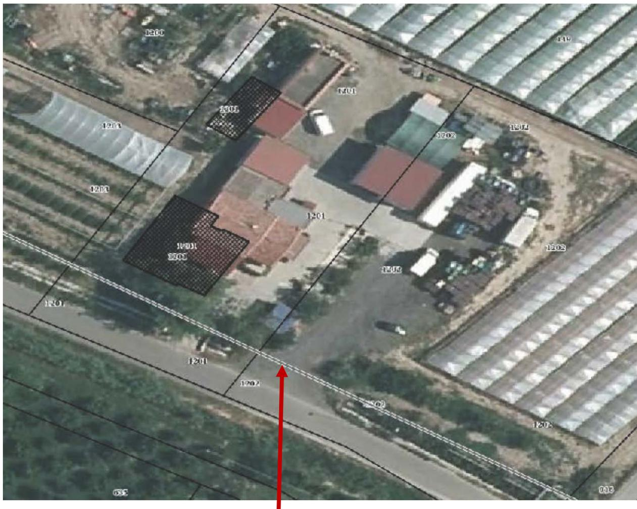
**POSIZIONE CONDOTTA FORZATA IRRIGUA Fi 400 mm in vetroresina interrata a profondità di mt. 1,50/2,00** (N.B.: il quadrilatero identificativo della particella n. 1201 risulta, nelle planimetrie aerofotogrammetriche, spostato di circa mt. 6 verso il basso e verso sx)
